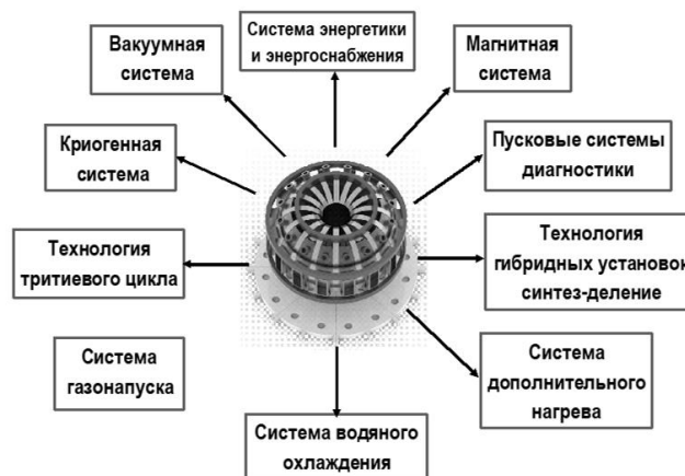
Рисунок 1. Инфраструктура токамака типа «Игнитор»
