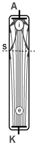
Рисунок. Схема движения заряженных частиц в трубке.
